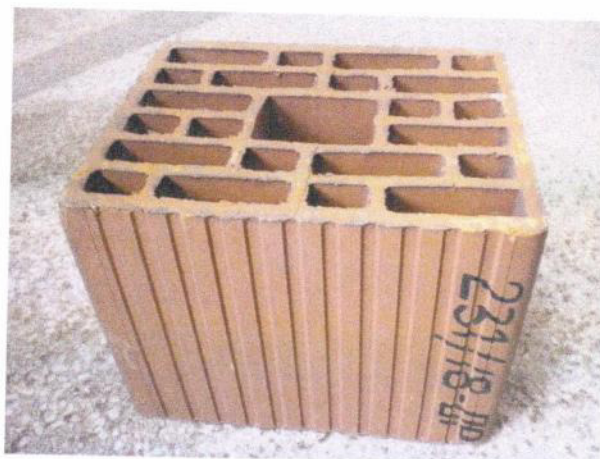
šuplji blok SRPS B.D1.015:2002-povučen / V - 250x190x190 – 100 - I
