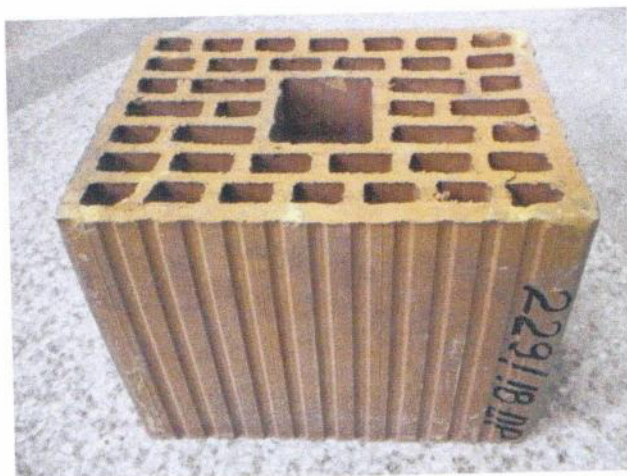
šuplji blok SRPS B.D1.015:2002-povučen / V - 250x190x190 – 100 - I
