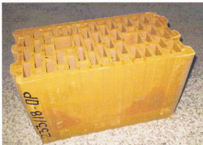
šuplji blok SRPS B.D1.015:2002-povučen / V - 380x200x238 – 100 - I
